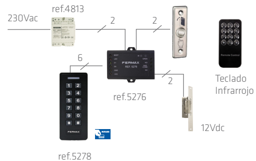
Medidas teclado: 50x122x21mm Medidas controlador: 65x54x9mm
